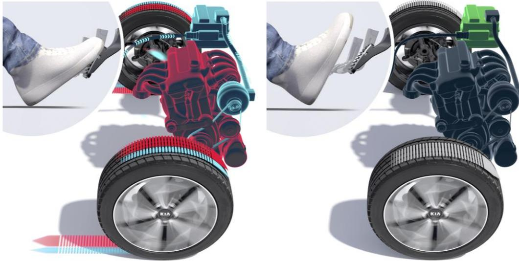
El sistema **MHEV\*** asiste al motor de combustión con empuje cuando es necesario, para descargarle de esfuerzos, conseguir menor consumo y menores emisiones de gases contaminantes. El sistema se recarga con velocidades de cruce y en bajadas. Igualmente, apaga el motor de combustión en detenciones para ahorrar combustible y evitar emisiones de gases contaminantes innecesarios, estando preparado para arrancar inmediatamente cuando se reanude la marcha.
