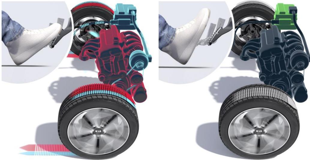
El sistema **MHEV** asiste al motor de combustión con empuje cuando es necesario, para descargarle de esfuerzos, conseguir menor consumo y menores emisiones de gases contaminantes. El sistema se recarga con velocidades de cruce y en bajadas. Igualmente, apaga el motor de combustión en detenciones para ahorrar combustible y evitar emisiones de gases contaminantes innecesarios, estando preparado para arrancar inmediatamente cuando se reanuda la marcha.
